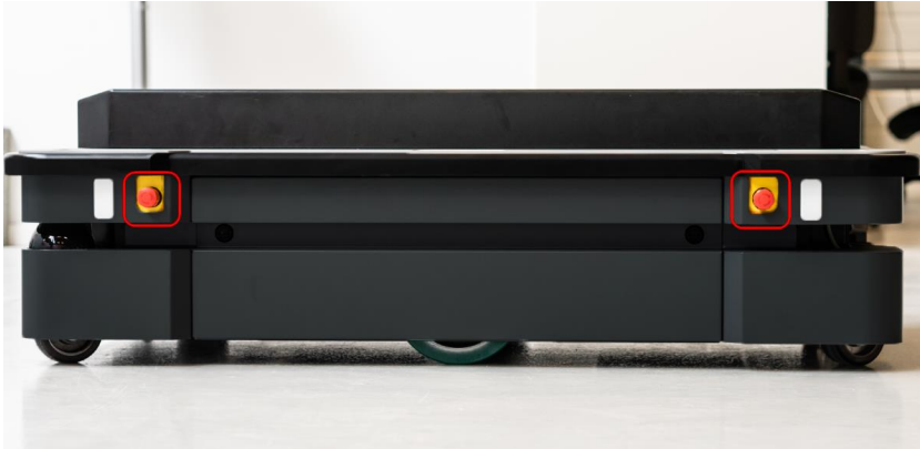
그림 10.1. MiR1350에는 네 개의 비상 정지 버튼과 전자 장치 인터페이스를 통해 추가 비상 정지 버튼으로 연결되는 옵션이 있습니다.
