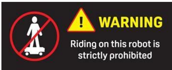
그림 4.1. 경고 라벨은 로봇이나 상부 모듈에 부착해야 합니다.
