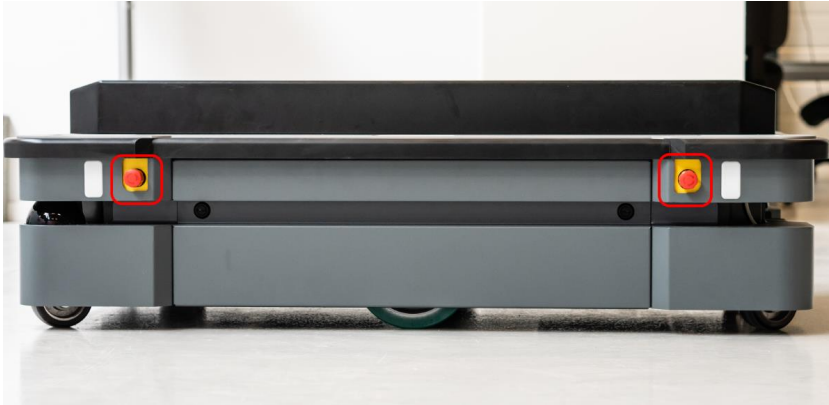
그림 10.1. MiR600에는 네 개의 비상 정지 버튼과 전자 장치 인터페이스를 통해 추가 비상 정지 버튼으로 연결되는 옵션이 있습니다.
